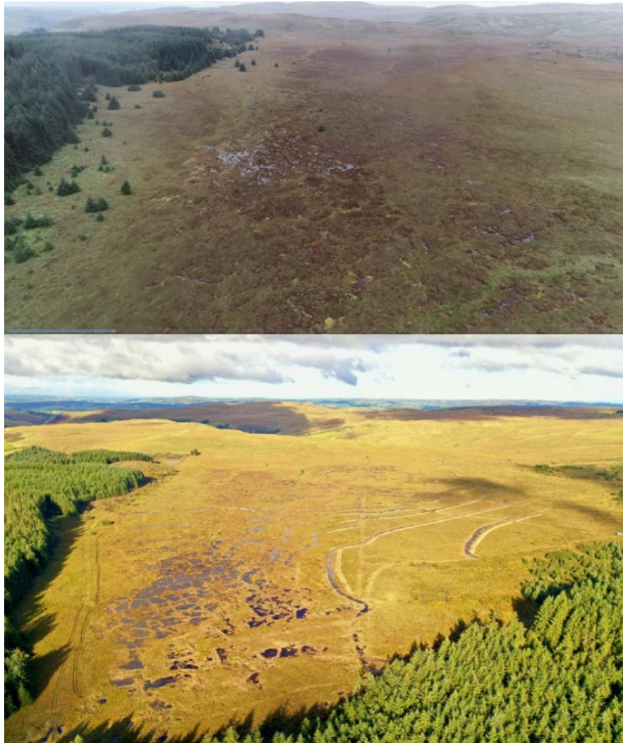
Ffigur 1. Cyn (ar y brig) ac ar ôl (ar y gwaelod) gwaith adfer hydrolegol ar SoDdGA Figyn Blaen Brefi ar Ystad Goetir Llywodraeth Cymru. Dengys y llun sut mae adeiladu cronïadau mawn a byndiau cyfuchlinol yn lleihau faint o ddŵr a gollir ac yn cynyddu cynefin pwll y mawndir.
